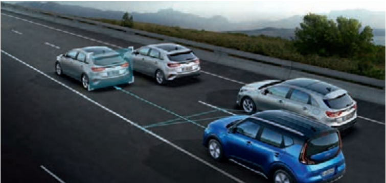
Spurfolgeassistent A . Mit dem Spurfolgeassistenten (Lane Follow Assist, LFA) bewegt sich der Kia e-Soul bereits im Bereich des teilautomatisierten Fahrens. Das System ermittelt per Kamera und Radar den Sicherheitsabstand zum vorausfahrenden Fahrzeug und übernimmt das Beschleunigen, Bremsen und Lenken. Zudem erkennt es die Fahrbahnmarkierungen und hält den Kia e-Soul dadurch mittig in seiner Fahrspur.
