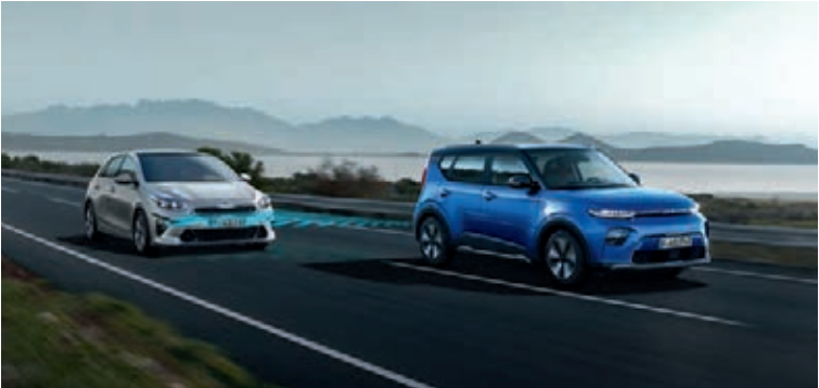
Spurwechselassistent A* und aktiver Querverkehrswarner A* . Der Spurwechselassistent mit Totwinkelwarner (Blind-Spot Collision Warning, BCW) überwacht per Radar die toten Winkel und warnt bei einem Fahrspurwechsel vor herannahenden Fahrzeugen. Der aktive Querverkehrswarner (Blind-Spot Collision-Avoidance Assist Rear, BCA-R) warnt beim Zurücksetzen aus Parklücken oder Einfahrten vor kreuzenden Fahrzeugen und bremst den Kia e-Soul bei Bedarf auch selbstständig ab.
