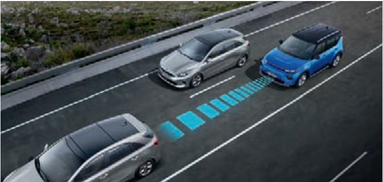
Adaptive Geschwindigkeitsregelanlage inkl. Stop-and-go-Funktion A . Per Kamera und Radar misst die adaptive Geschwindigkeitsregelanlage (Smart Cruise Control, SCC) die Distanz zum vorausfahrenden Fahrzeug sowie dessen Geschwindigkeit. Wird der festgelegte Sicherheitsabstand unterschritten, bremst das System den Kia e-Soul ab, wenn nötig bis zum Stillstand. Sobald die Verkehrssituation es zulässt, beschleunigt der Kia e-Soul wieder – bei freier Fahrt bis zur eingestellten Geschwindigkeit.
