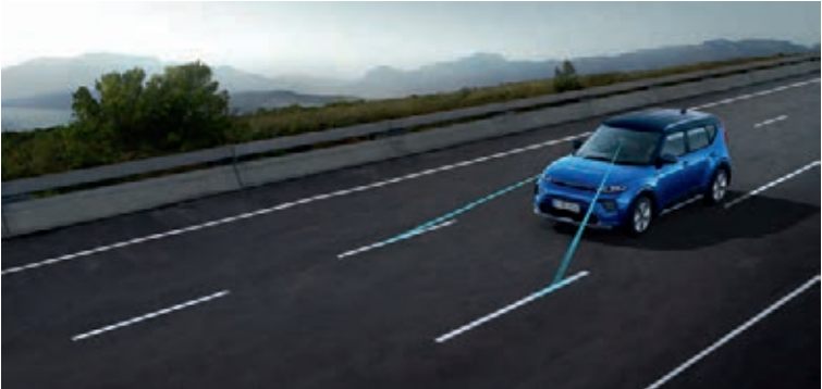
Aktiver Spurhalteassistent A , Müdigkeitswarner A und Fernlichtassistent A . Verlässt der Kia e-Soul unbeabsichtigt die Fahrspur, weist der Spurhalteassistent (Lane Keeping Assist, LKA) dich darauf hin und lenkt zugleich geringfügig gegen. Bei nachlassender Konzentration rät dir der Müdigkeitswarner (Driver Attention Warning, DAW) durch akustische und optische Signale zu einer Pause. Der Fernlichtassistent (High Beam Assist, HBA) blendet bei Bedarf automatisch ab und, sobald die Verkehrssituation es zulässt, wieder auf.
