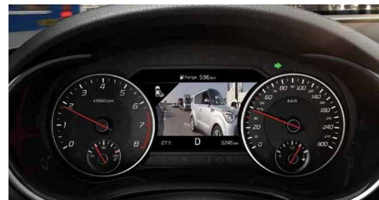
**Aktiver Totwinkelassistent mit Monitoranzeige<sup>A</sup>.** Dir ist ein Warnsymbol nicht genug? Dann ist der aktive Totwinkelassistent mit Monitoranzeige (Blind-Spot View Monitor, BVM) genau das Richtige für dich. Er gibt dir mithilfe der Seitenkameras und des digitalen Kombiinstrumentes Einblick in die toten Winkel. Setze einfach links den Blinker und schon erscheint das Bild der linken Kamera im Instrumentendisplay. Wenn du rechts blinkst, entsprechend das Bild der rechten Kamera.
