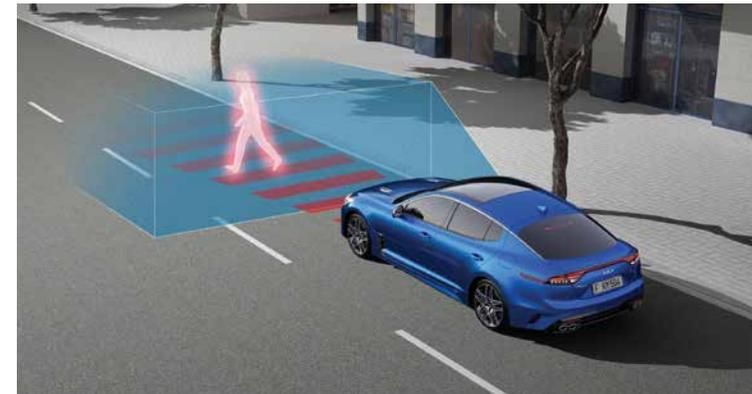
**Frontkollisionwarner<sup>A</sup>.** Per Kamera und Radarsensoren kann der Frontkollisionwarner (Forward Collision-Avoidance Assist, FCA) die Gefahr einer Kollision mit Fahrzeugen, Fußgängern, Radfahrern oder Hindernissen erkennen, dich warnen und den Kia Stinger sogar mit maximaler Bremskraft abbremsen, um einen Aufprall zu vermeiden oder dessen Folgen zu verringern.
