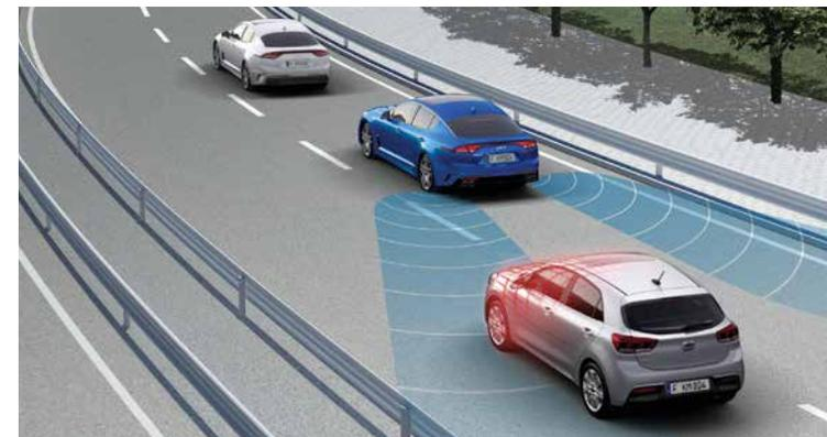
**Aktiver Totwinkelassistent<sup>A</sup>.** Der aktive Totwinkelassistent (Blind-Spot Collision-Avoidance Assist, BCA) überwacht mit Radarsensoren an den Seiten und dem Heck des Kia Stinger die toten Winkel. Entdeckt der Assistent ein herannahendes Fahrzeug, warnt er dich durch optische Hinweise vor einem Fahrspurwechsel. Bei Kollisionsrisiko erzeugt er eine visuelle und akustische Warnung. Falls nötig, bremst er das Fahrzeug ab und verhindert, dass du deine Spur verlässt.
