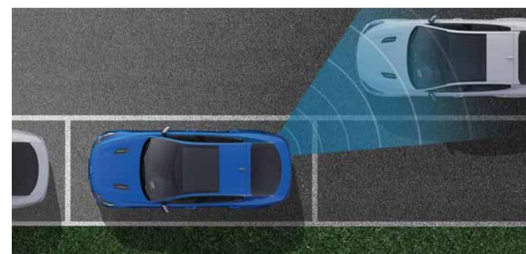
**Ausstiegswarner<sup>A</sup>.** Um zu vermeiden, dass die Fondpassagiere beim Öffnen der hinteren Türen ein herannahendes Fahrzeug oder Fahrrad übersehen, nutzt der Kia Stinger seine hinteren Radarsensoren besonders intelligent für den Ausstiegswarner (Safe Exit Warning, SEW). Das System schlägt im Notfall akustisch und optisch Alarm. So kommt es gar nicht erst zu gefährlichen Situationen.
