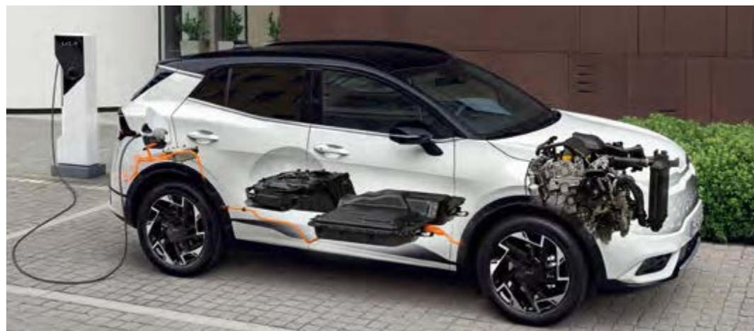
**Drive-Mode.** Über die Hybrid/Elektro-Taste (HEV/EV) in der Mittelkonsole kannst du zwischen Elektro- und Hybridantrieb wählen. Im EV-Modus – ideal für den Stadtverkehr – nutzt der Sportage Plug-in Hybrid vorrangig elektrische Energie für emissionsfreies Fahren<sup>1</sup>. Im HEV-Modus arbeitet er mit beiden Energiequellen und wechselt je nach Situation zwischen dem reinen Benzinmotor, dem reinen Elektromotor oder beiden gleichzeitig.
