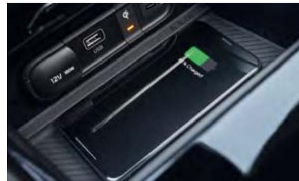
**Induktive Ladestation für Smartphones\***. Nie wieder ein leerer Akku. Nie wieder nach dem Ladekabel suchen. Denn der Kia Sportage ist mit einer induktiven Smartphone-Ladestation ausgestattet, die kabelloses Hochgeschwindigkeitsladen mit 15 W bietet. Einfach dein kompatibles Smartphone auf das Ladefeld legen und schon startet der Ladevorgang während der Fahrt ganz automatisch.
