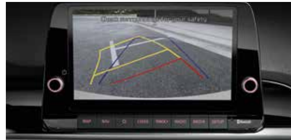
Rückfahrkamera mit dynamischen Hilfslinien AA . Beim Rückwärtsfahren erscheinen auf dem Touchscreen* des Audio- oder Navigationssystems* die Kamerabilder inklusive Hilfslinien, die dir das Manövrieren erleichtern.
