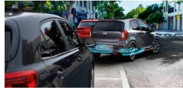
Parkensensoren hinten AA . Rückwärts einparken ohne Angst vor Beulen oder Kratzern: Ein Signalton warnt dich, wenn du einem Fahrzeug oder einem Hindernis zu nahe kommst.
